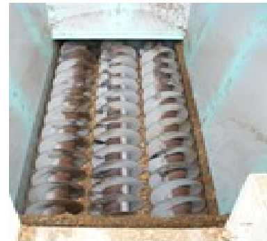
Einbau in Austragsschnecke (Holzkraftwerk)
